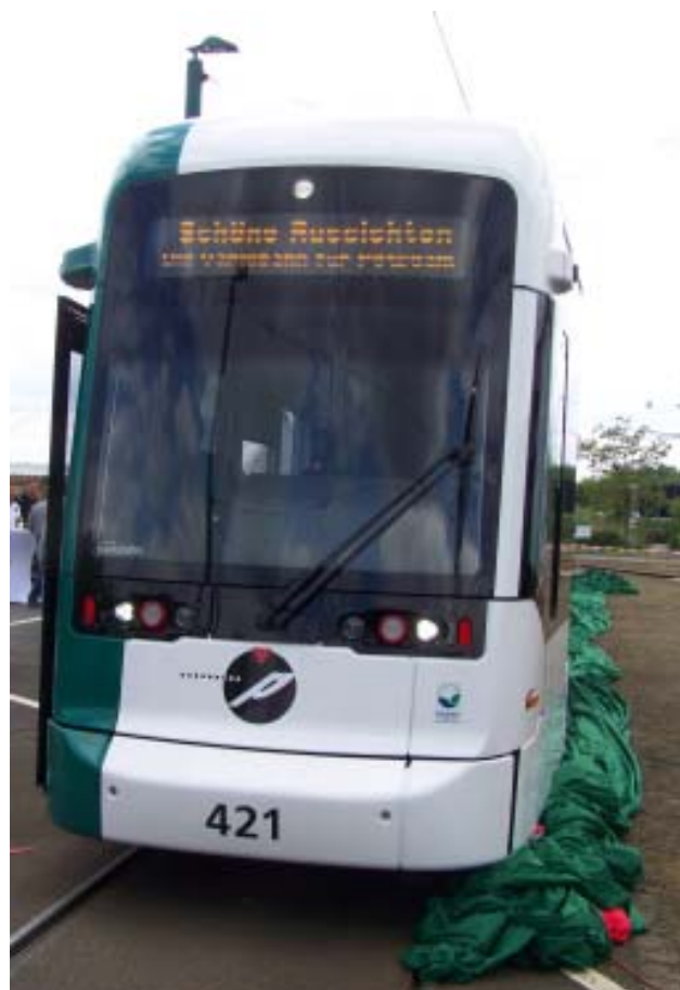
Bild 2. Besonders auffällig: die als optische Verlängerung der Frontscheibe gestaltete leicht vorgezogene Bugschürze (Bild: ViP Verkehrsbetrieb Potsdam GmbH).
